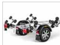
Rullesystem udviklet specielt til gummibåde.
