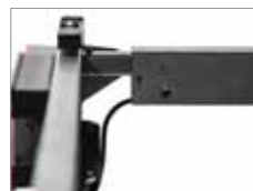
V-formet og lukket trækstang for optimal beskyttelse af kabler
