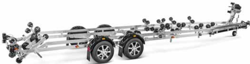
Dobbelte heavy duty superruller
