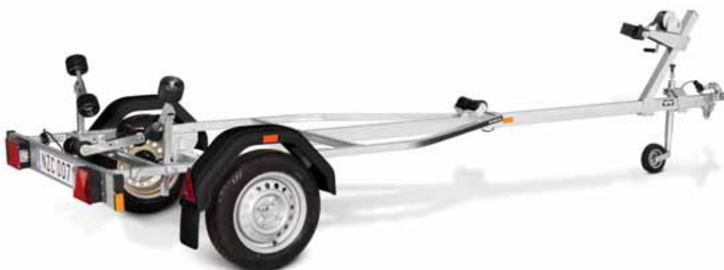
Lygtebom med kliklukketøjer for let og hurtig montering og demontering.
