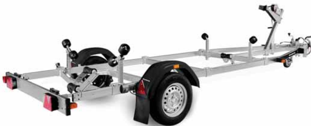
Lygtebom med kliklukketøjer for let og hurtig montering og demontering.
