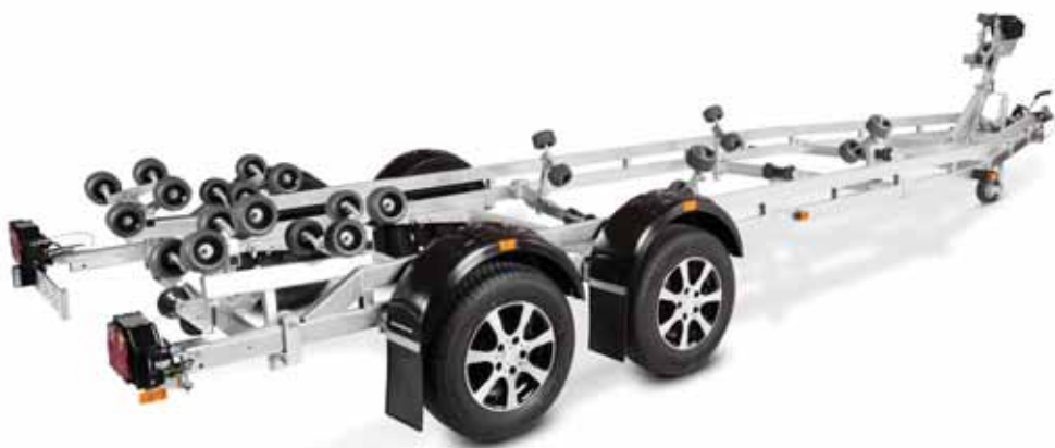
Dobbelte heavy duty superruller
