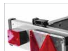
Lygtebom med kliklukketøjer for let og hurtig montering og demontering.
