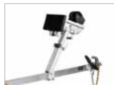
Justerbart spiltår og flad støttepude for sikkert stop af gummibåden.
